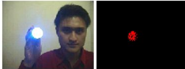
Gambar 5. Citra perangkat genggam penginstruksi, 640x480 piksel, pada jarak 50 cm dari kamera; citra bmp (kiri), citra bmp1 (kanan).
