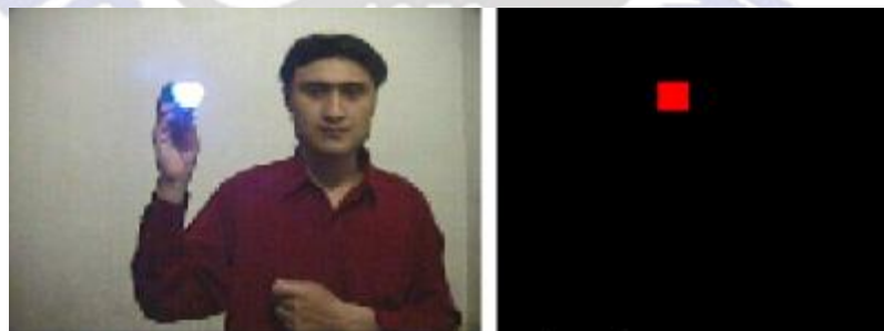
Gambar 6. Pembentukan luasan dari data terpilih, 640x480 piksel, pada jarak 1 meter dari kamera; citra bmp (kiri), citra bmp1 (kanan).
