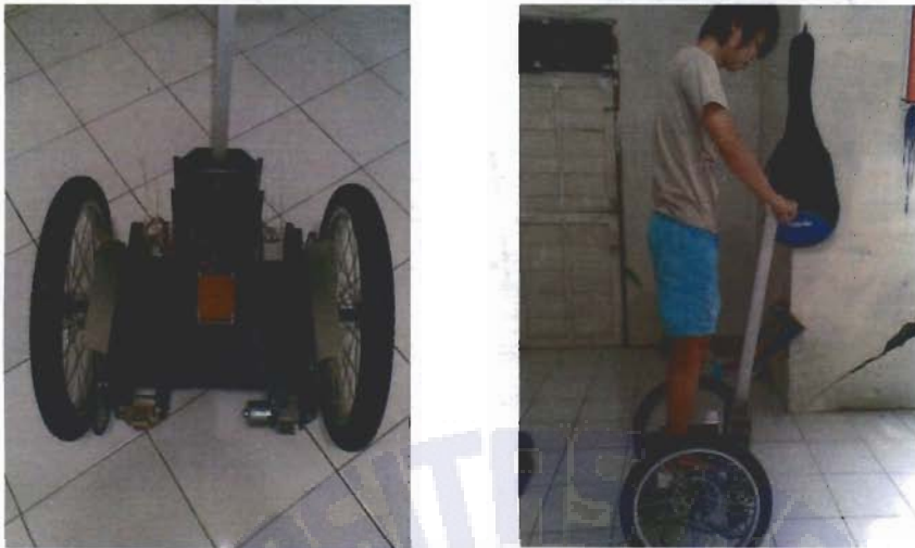
Gambar 3.1. Segway Yang Telah Di realisasikan
